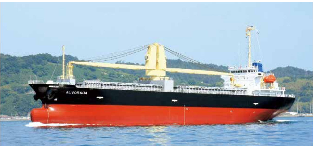
D/W 11,600T型貨物船 ALVORADA 定格出力：1,471kW×1 竣工：2010年7月 L 105.4×B 20.0×D 14.3
